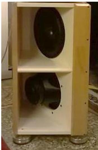
Il subwoofer «**Basso Doppio**» caricato a dipolo, con tutti i vantaggi che questo sistema garantisce, è dotato di un amplificatore con telecomando, DSP per il pilotaggio, ingresso analogico e digitale (USB e S/PDIF).
