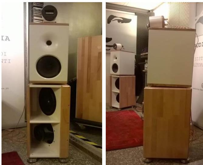
Il sistema si sviluppa attorno all'unità «**Concerto Solo**», dotata di altoparlante a gamma intera monomembrana di efficienza medio alta (94 dB). A rifinire l'estremo acuto (oltre i 10 KHz), un tweeter anteriore con guida d'onda e uno posteriore per creare il giusto campo riverberato.
